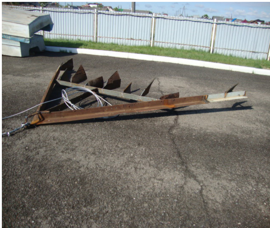
Рисунок 3. Рыхлитель ила конструкции Сладковского рыбхоза. Длина остро отточенной грани агрегата - 3 м.
